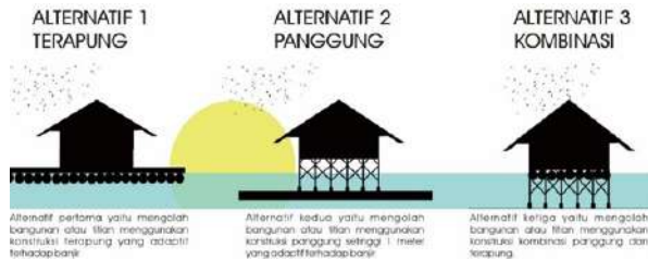
Gambar 20. Alternatif Struktur Bangunan (Sumber: Konstruksi Penulis, 2021)
