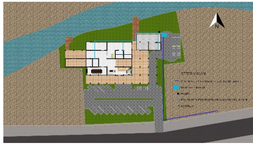
Gambar 17 Utilitas Air Bersih
