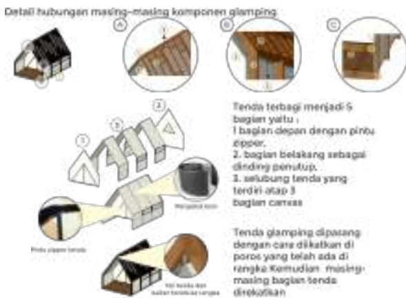
Gambar 16. Konstruksi Glamping Semi Permanen-Bongkar Pasang Sumber: Penulis, 2024
