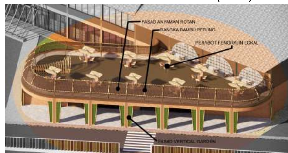
Gambar 16. Contoh Pengaplikasian Material Lokal pada Balkon Bangunan. Sumber: Analisis Penulis (2021).
