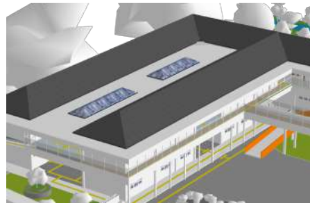
Gambar 12. Skylight sebagai akses pencahayaan alami Sumber: Penulis (2022)
