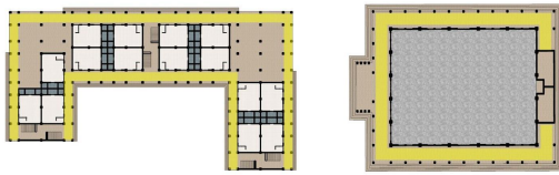
Selasar pada bangunan Asrama dan Masjid
